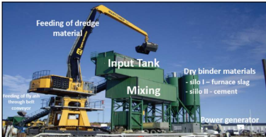
Figur 4-4 Exempel på inblandningsstation för processtabilisering i Åbo (Lagerlund et al., 2010).
